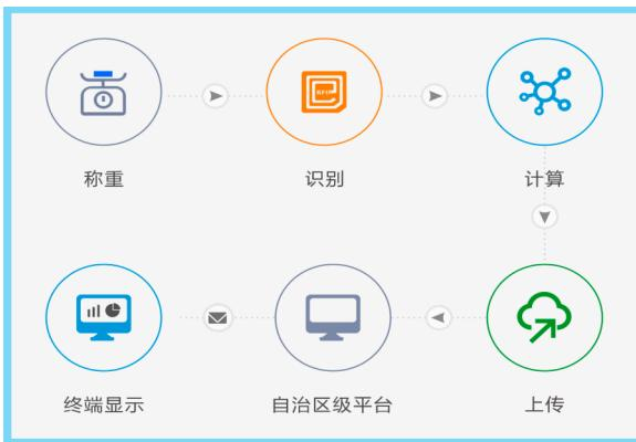
二是数据自动化填报统计。系统集成了物联网、RFID标识、边缘计算数据处理算法、4G传输等技术，实现了分类垃圾信息标识识别、分类称重计量、数据自动上传、溯源关联等自动化功能。全区公共机构均可通过系统进行数据直报和凭证上传，形成统一规范的“可回收物、厨余垃圾、有害垃圾”数据台账、清运台账。同时，系统还具备数据手动填报功能，供未应用标准化管理模式的公共机构报送相关数据。
